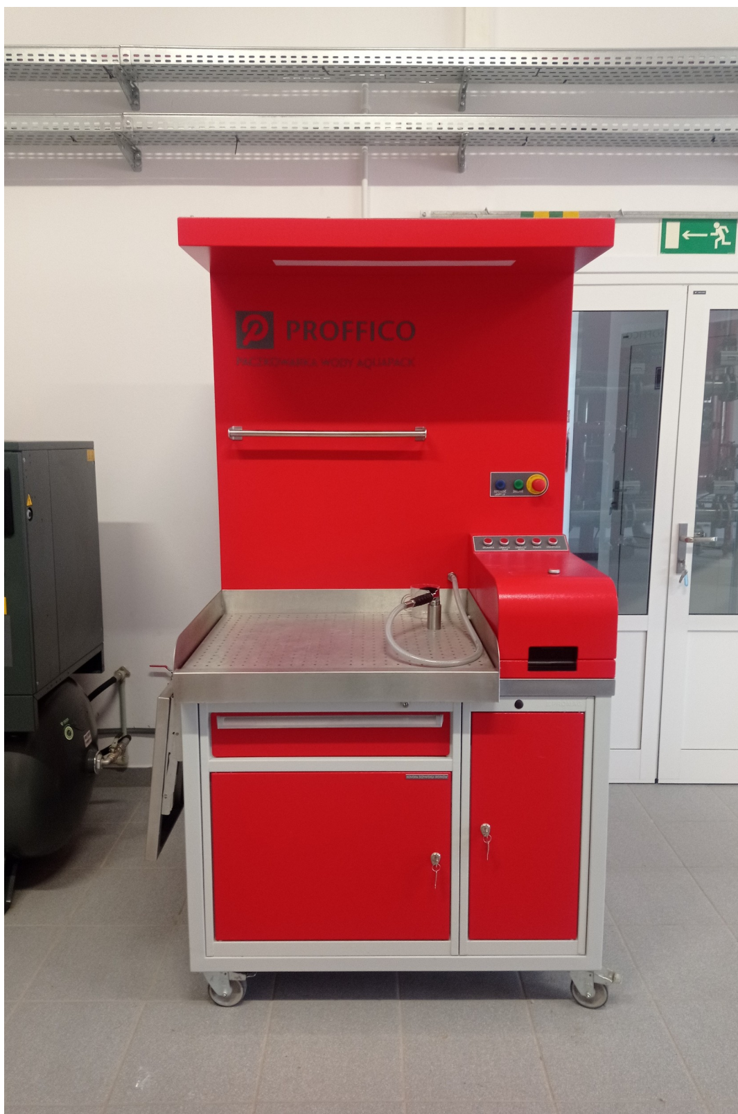
Zdjęcie nr 13.1. SUW Sahryń – paczkowarka wody.
